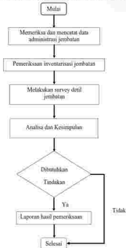
Gambar 17. Diagram Alir Kegiatan Survey Kondisi Jembatan
